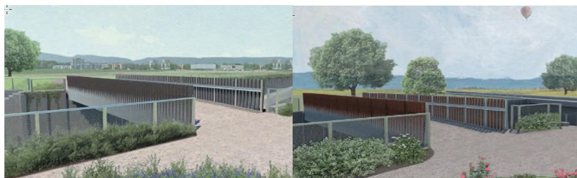
La largeur de cette passerelle sera de 4,0m. Un éclairage est projeté dans une phase ultérieure ; les incorporés seront déjà posés.
